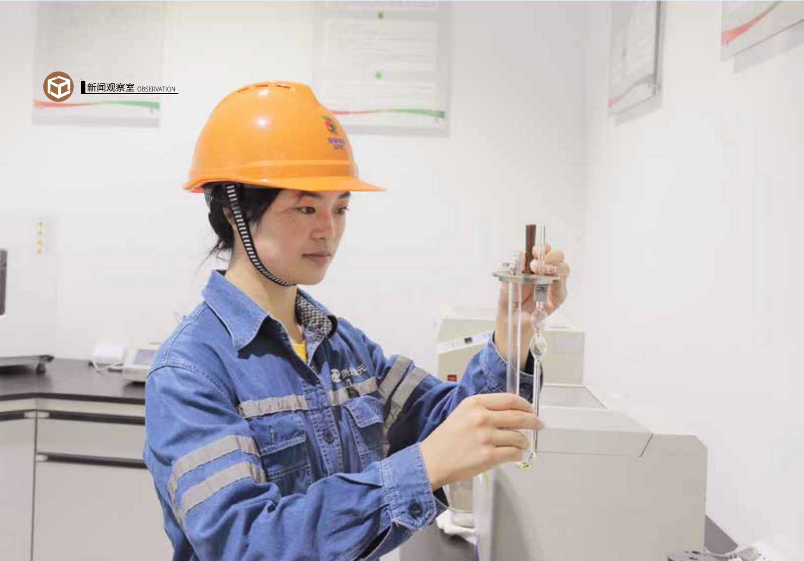
●检修中心职工利用十秒思考法进行变压油油样化验
